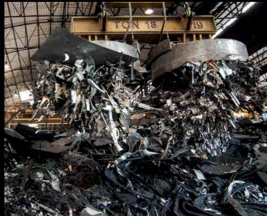
L'utilizzo di forni EAF al posto degli Blast Furnace, consente l'utilizzo del rottame ferroso come materia prima dando un ciclo di vita infinita ai manufatti in acciaio che ridiventeranno rottame e quindi nuovamente materia prima.
